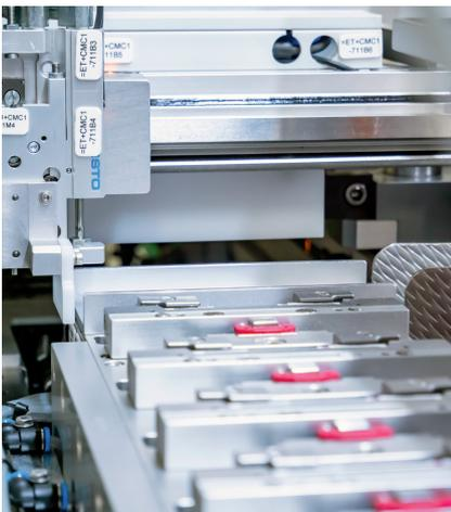
Schneidestation: Sie macht aus dem Kartenmaterial einzelne Teststreifen und sortiert Fehlstellen vollautomatisch aus.
